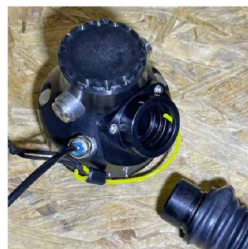
Eigenentwicklung: Schlauchverbinder mit um- laufender Rundschnur
