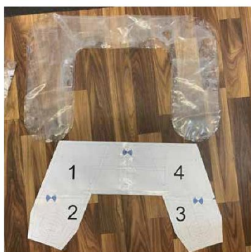
Schnittoptimierung an den ersten Gegenlungen- versionen aus TPU-Folie (Diamond SM System).
